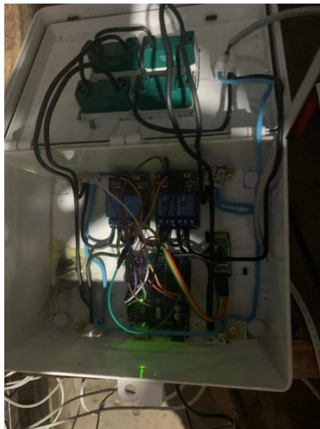
รูปที่ ก.8 วงจร Smart Light
