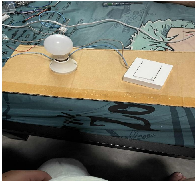
รูปที่ ก.3 การทดลองเปิด/ปิด หลอดไฟแบบManual
